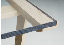
TA-006 テーブルは、25ミリ厚のアクリル天板の側面をテーパー加工し、木製フレームに落とし込んであります。
