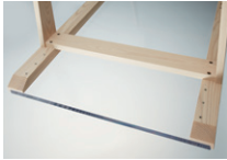
TA-006 テーブルは、4箇所の固定ボルトを付け替えることにより80ミリピッチで脚部の位置を変更できます。
