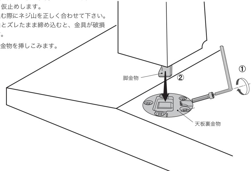
③脚と天板の角がズレないように、手で合わせながら、仮止めしたボルトを締めてください。
