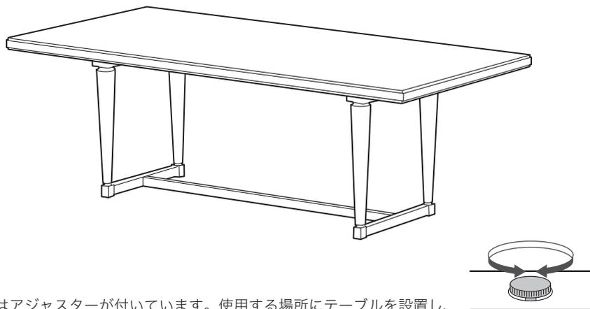
脚先にはアジャスターが付いています。使用する場所にテーブルを設置し、ガタつく場合は浮いている脚のアジャスターを回し調整して下さい。
