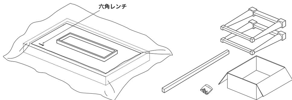
天板は開梱すると裏面が上になっています。脚部を組立てた後は天板を箱から取り出さずにそのまま脚部を組立てられます。ボルトは脚部と同梱されています。
